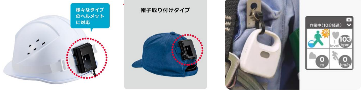
図1 安全管理システムにおけるウェアラブルデバイスの一例(左:作業者安全モニタリングシステム(村田製作所)[9], 右:安全見守りくん(日鉄ソリューションズ)[10])
