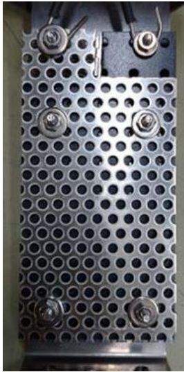
図5 オゾン生成電極 (ろ過器のオゾン消毒)
