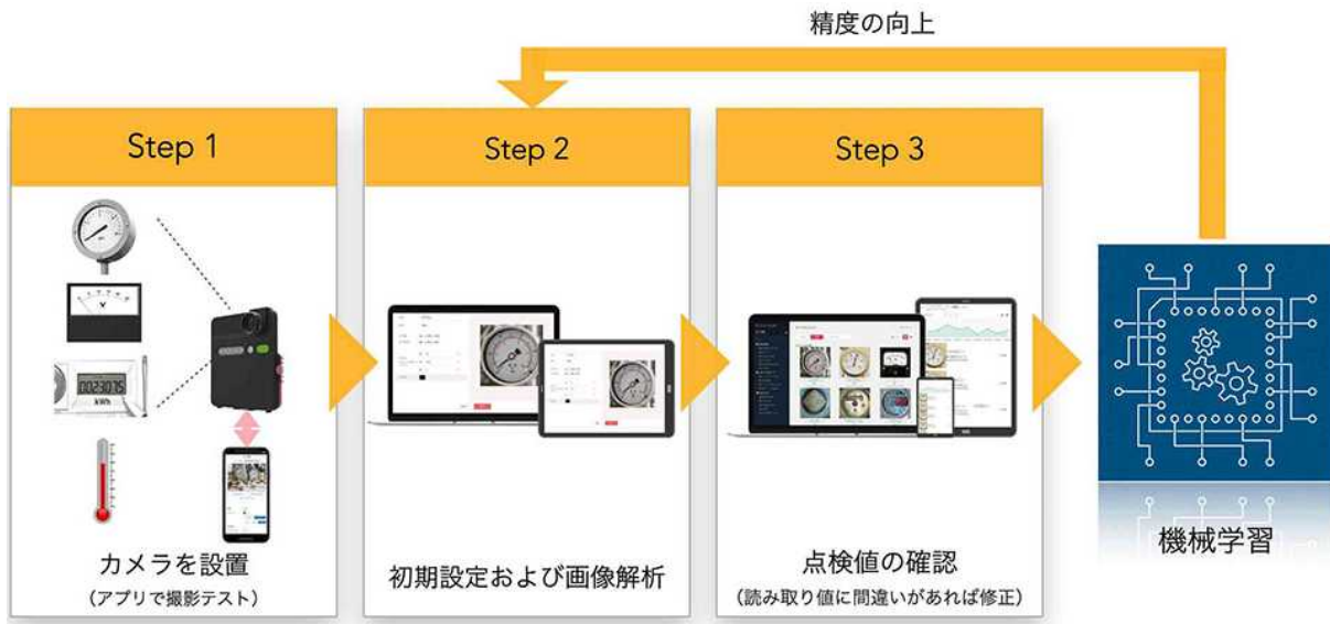
図8-1 IoTカメラによる日常点検のフロー 1)
