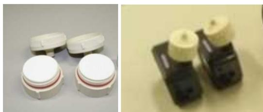
図 2-6-1 捕集フィルター及びサンプリング
