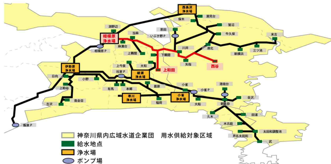
図-1 神奈川県内広域水道企業団が管理する浄水場と給水地点。本研究では相模原浄水場から上和田および西谷給水地点までに低減する残留塩素量を予測するモデルを構築した
