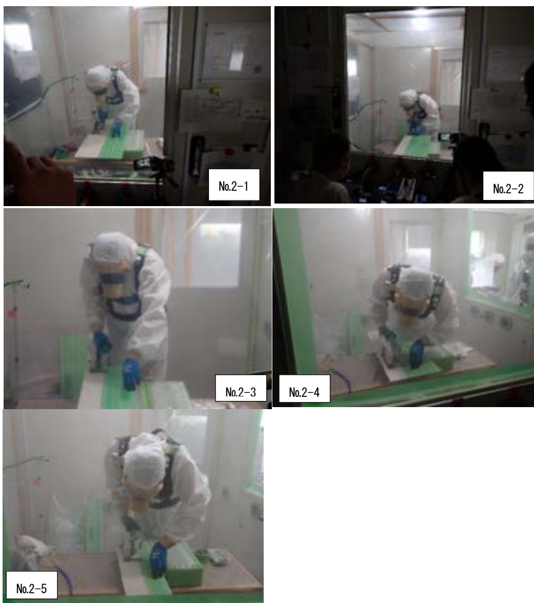
図 16 切断作業実施状況（石綿含有スレート板）
