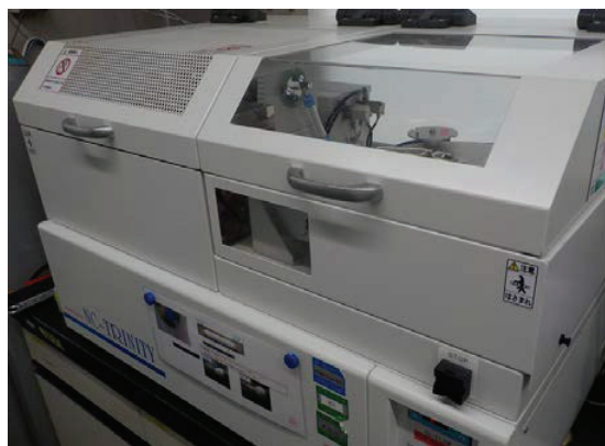
図 B 4 改良デュマ法で用いた装置 ((SUMIGRAPH NC-TRINITY, 株式会社住友分析センター製)
