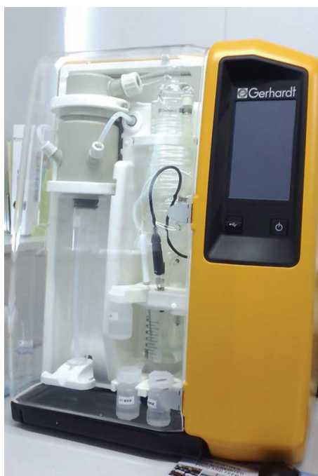
図 B 3 自動蒸留滴定装置((VAPODEST 500, ゲルハルトジャパン株式会社製)
