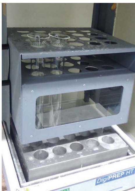
図 B 2 加熱分解装置((DigiPREP HT250-20, 株式会社 SCP SCIENCE 製)
