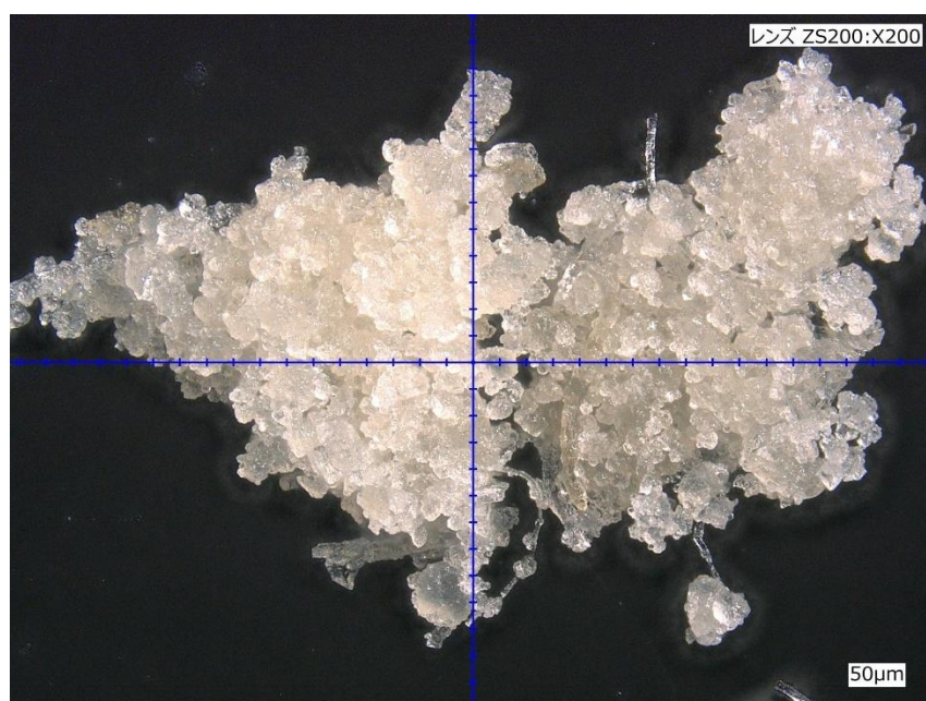
図13 スプレードライヤで作製した鶏肉パウダーの顕微鏡写真
