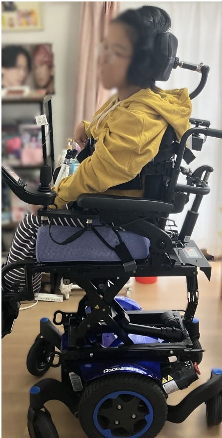
図3 サンライズメディカル社製QUICKIE Q300 リフト機能を使用し座面を挙上した状態
