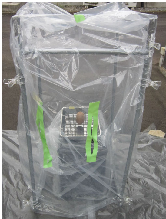
付録 4. 噴霧実験で使用したドリフト防止チャンバーと噴霧の様子
