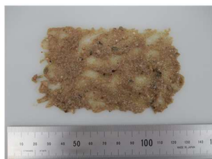
凍結粉砕法 ドライアイス予冷方式
