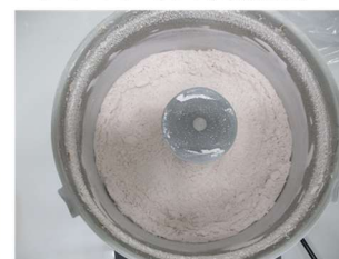
凍結粉砕法 ドライアイス予冷方式
