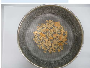
図 B-19. ホモジナイズまたは振とう抽出後の残渣
