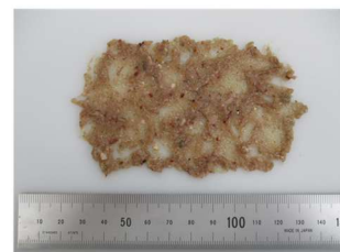
凍結粉砕法 ドライアイス予備凍結方式
