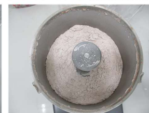
凍結粉砕法 ドライアイス予備凍結方式
