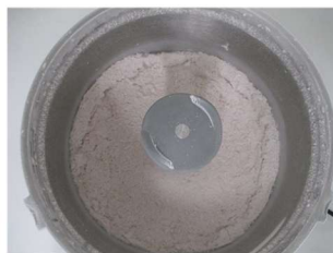
凍結粉砕法 ドライアイス予冷方式
