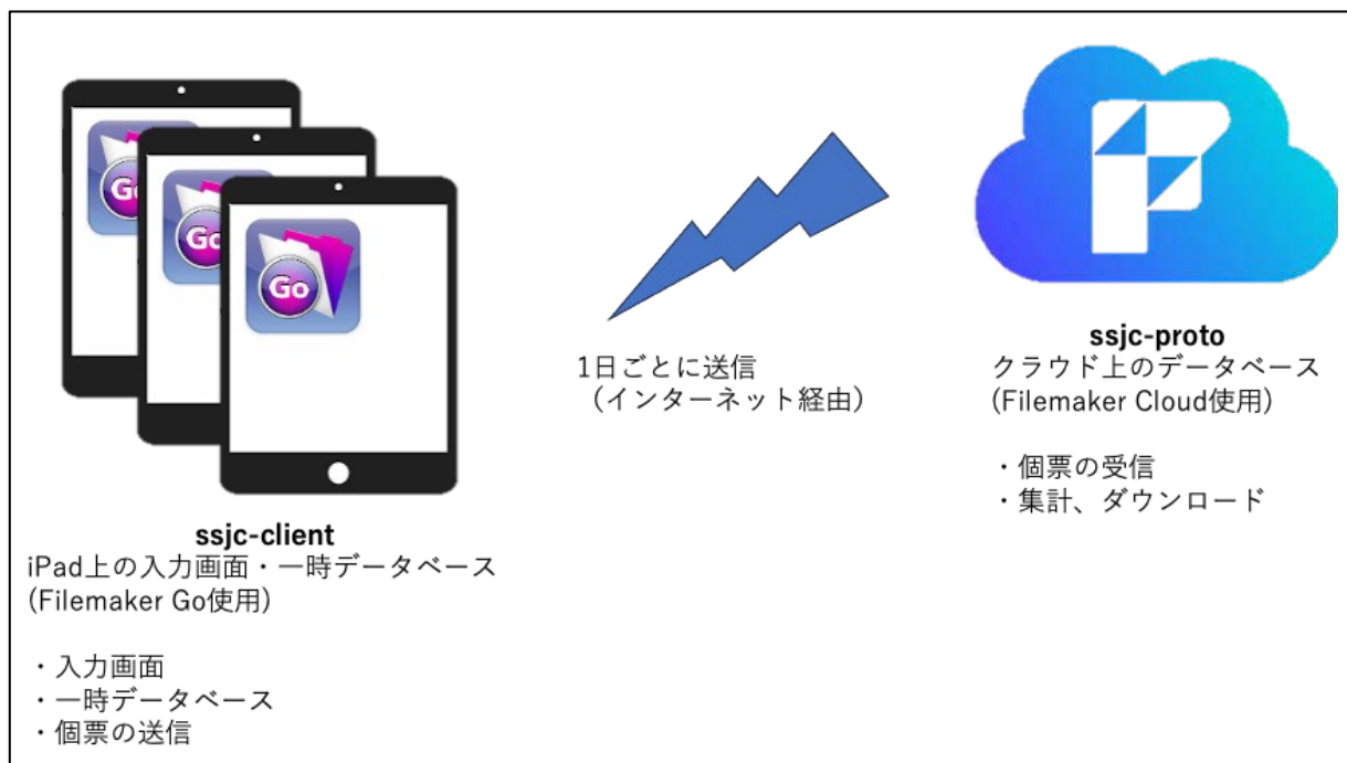
図2 システム構成： (通信環境が整備されていない調査会場であっても調査が可能である。)
