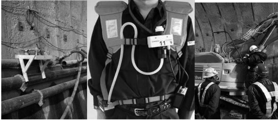
【図表 2-18：定点測定・個人サンプリング・車両系機械を用いた測定（左から）】
