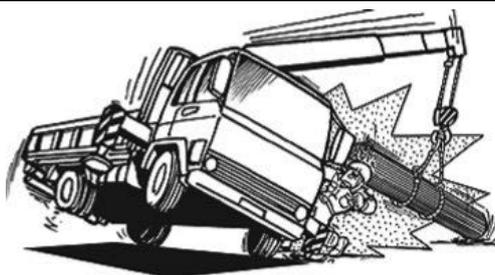
移動式クレーンの過負荷防止装置とは、この図のように移動式クレーンに過負荷が掛かって転倒するようなことを防止するため、過負荷がかかる前に、自動的にジブの危険な動きを停止したりする装置である。
