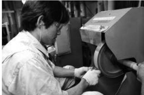
図 25 面取り盤の例 (家具工房ひょうたん蔵のウェブサイト (<https://www.hyo-tan.com/2016/11/19/%E8%B6%85%E4%BB%95%E4%B8%8A%E3%81%92%E9%9D%A2%E5%8F%96%E3%82%8A%E7%9B%A4/>, 2023 年 8 月 28 日閲覧) から)
