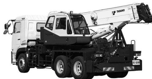
図 21 トラッククレーン
