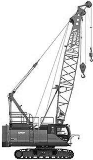
図 18 クローラークレーン
