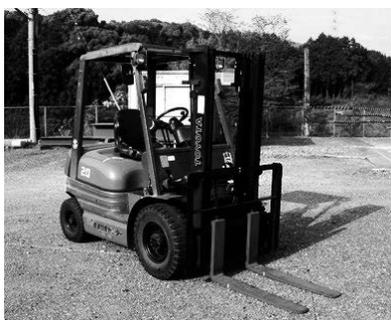
フォークリフトと次項のフォークローダーの違いは、フォークの上げ下げ動作の違いにある。フォークローダーがフォークを上下させるためにはアームの動作を行う（そのため、荷を前方にも伸ばせる）のに対し、フォークリフトはマストによってフォークを上下させる<sup>26</sup>。
