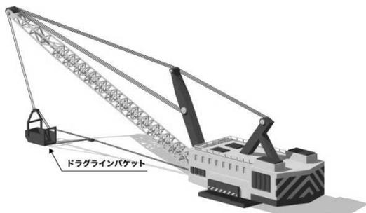
土工事用掘削機の一つで、機体から伸ばしたブームの先に吊るしたバケットを振り子のように前方に投げ、引き寄せながら土砂をすくう仕組みとなっており、機械を移動させずに広範囲の掘削ができる 47。
