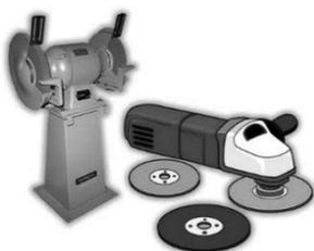
研削「といし」部分は誤った取扱いをすると破壊することがあり、重大な災害につながる恐れがある。そこで、研削といしを取替えたり、その際に試運転を行う業務に従事する労働者には研削といしの危険性および安全な取扱いについて必要な知識・技術を身に付けさせることを事業者に求めたものである。
