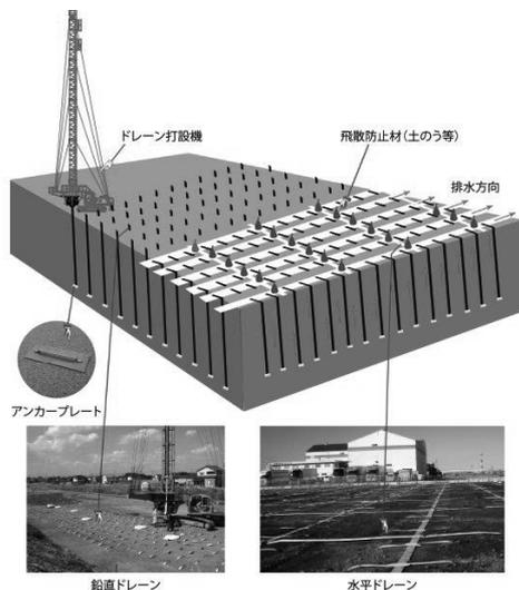
ドレーンとは排水を意味し、ペーパー・ドレーン・マシーンとは、埋立地等の地盤改良を目的とした基礎工事用の機械の 1 つで、紙状のシートを少し地上に出るようにして埋立地に埋めて地中の水分を吸わせ、蒸発させて水分を飛ばすことで地盤を改良する工法。紙
