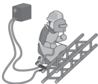
アークとは、高温で強い光を発する気体放電現象の一種である。炭素やタングステンなどの電極を接触させ、電流を流している状態で電極を引き離すと電極間にアークが発生する（左図参照）。身近なアークの例として、通電中のプラグをコンセントから引き抜いたときに発生するスパークが挙げられる。
