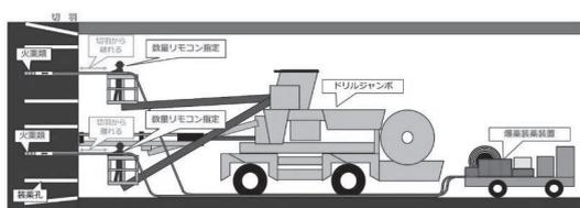
図1 本装置を用いた爆薬装薬構成
