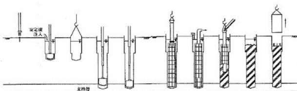
ドリリングバケットを回転させて地盤を掘削し、バケット内部に収納された土砂を地上に排土する工法 56。
