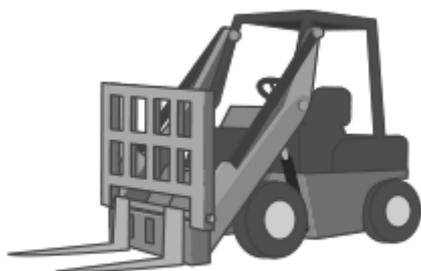
ショベルローダーは、原則として車体前方のショベル（バケット）をリフトアームで上下させて主にバラ物の荷役を行う車両を指し、フォークローダーは、原則として車体前方のフォークをリフトアームで上下させて材木などの荷役を行う車両をいう<sup>30</sup>。
