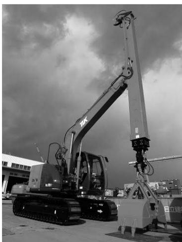
クラムシエルとは、ブームの先端にワイヤロープで吊られたクラムシエルバケットから、二枚貝のように土砂をつかんで掘削する掘削機をいう 49。
