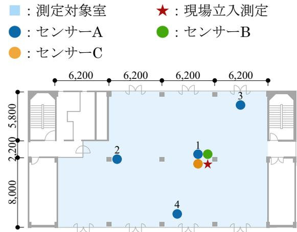
図 3-1-2 A ビル 3 階平面概要図
