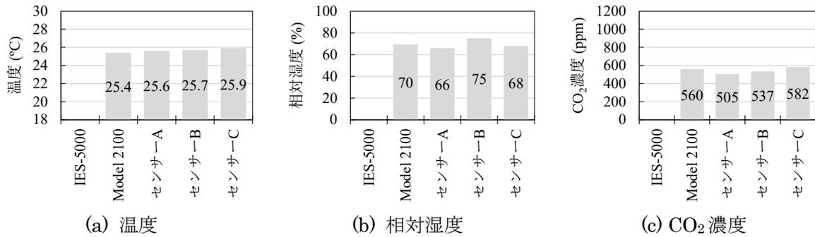
図 3-2-12 小型測定器と現場立入測定と比較 (H ビル 6 階, 2023/9/4 15:10)
