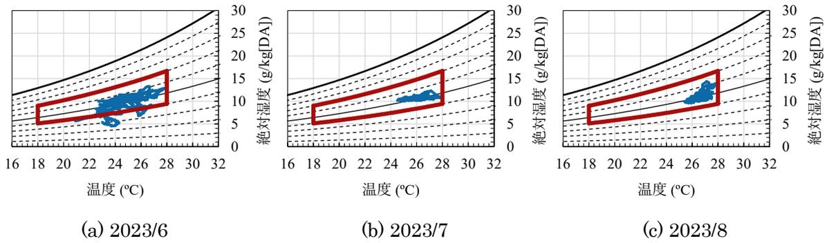
図 3-1-40 室内温湿度 (Cビル, 2023/6 - 2023/8, 平日 9 - 18 時)
