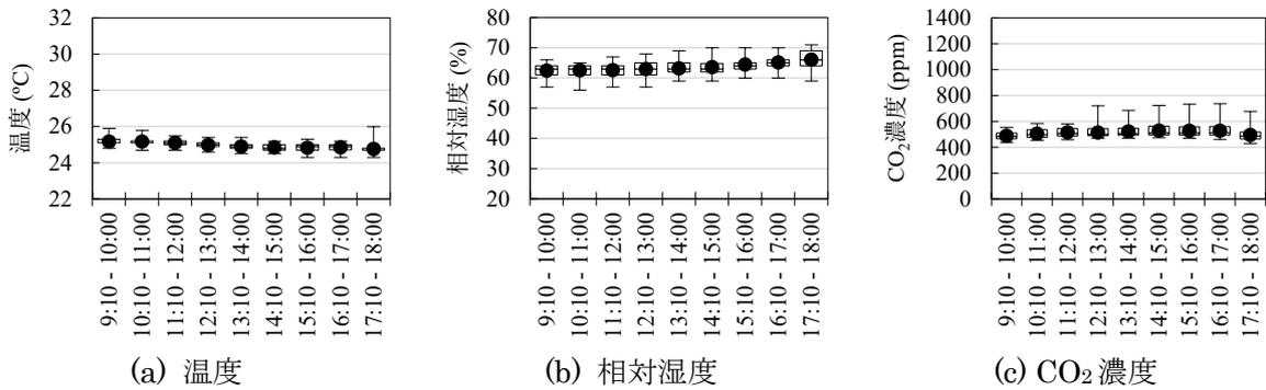
図 3-1-63 室内環境の時別結果 (Hビル6階, 2023/7/31 - 2023/8/31, 平日 9 - 18時)
