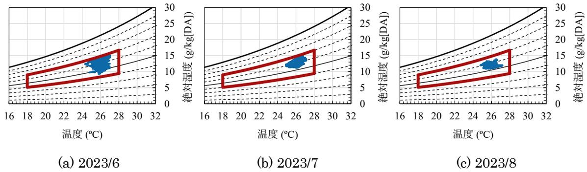
図 3-1-52 室内温湿度 (Gビル1階, 2023/6 - 2023/8, 平日 9 - 18時)
