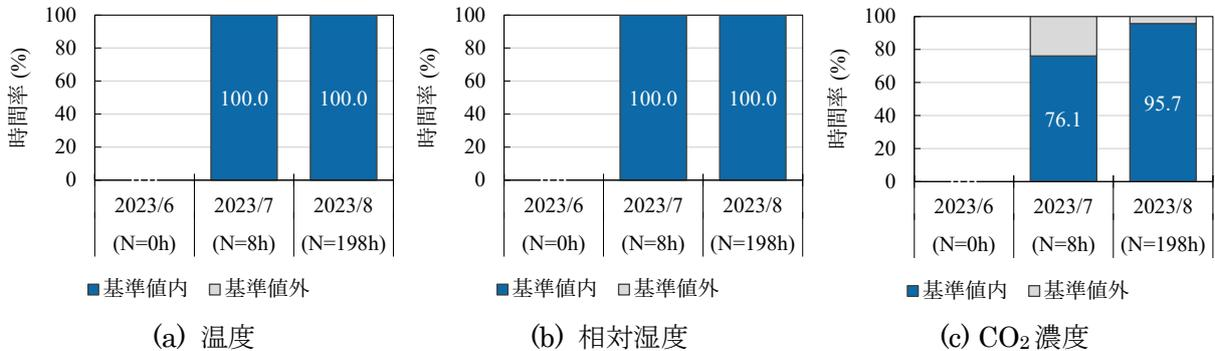
図 3-1-61 基準値内時間率 (Hビル4階, 2023/7/31 - 2023/8/31, 平日 9 - 18時)
