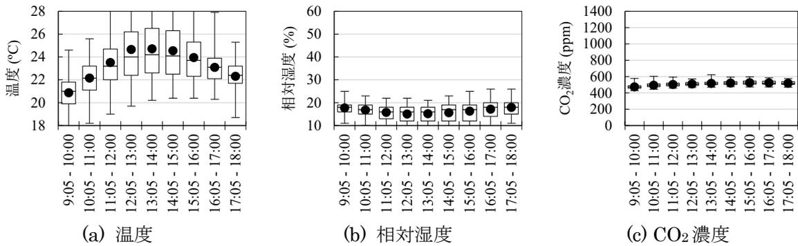
図 3-1-79 室内環境の時別結果 (Bビル3階, 2023/12 - 2024/2, 平日9 - 18時)
