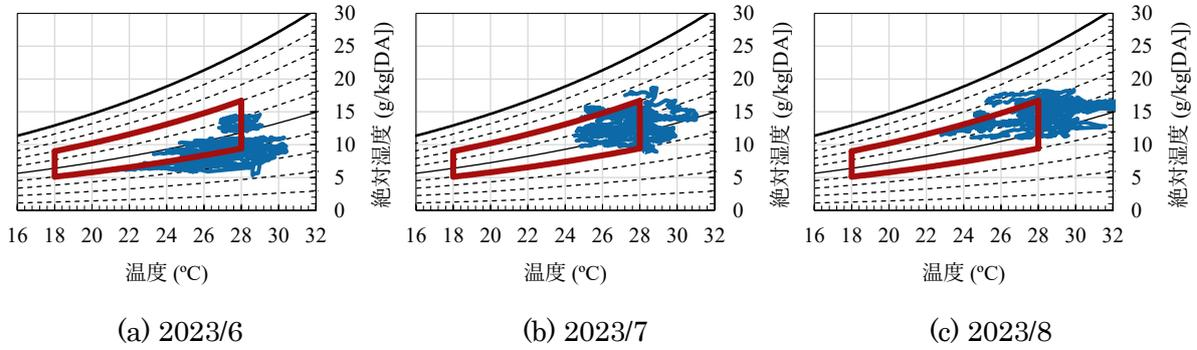
図 3-1-36 室内温湿度 (Bビル3階, 2023/6-2023/8, 平日9-18時)
