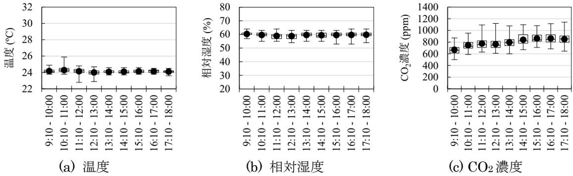
図 3-1-59 室内環境の時別結果 (Hビル4階, 2023/7/31 - 2023/8/31, 平日 9 - 18時)
