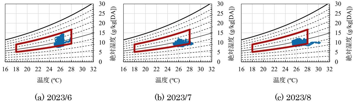
図 3-1-24 室内温湿度 (A ビル 2 階, 2023/6 – 2023/8, 平日 9 – 18 時)
