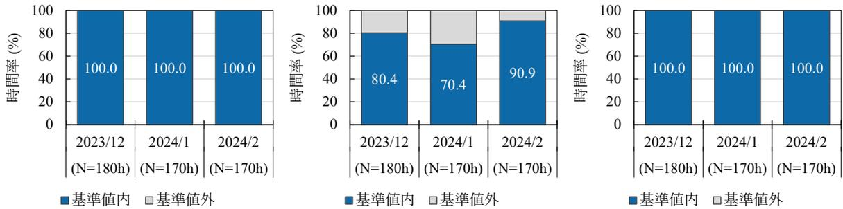
図 3-1-73 基準値内時間率 (Aビル3階, 2023/12 - 2024/2, 平日9 - 18時)
