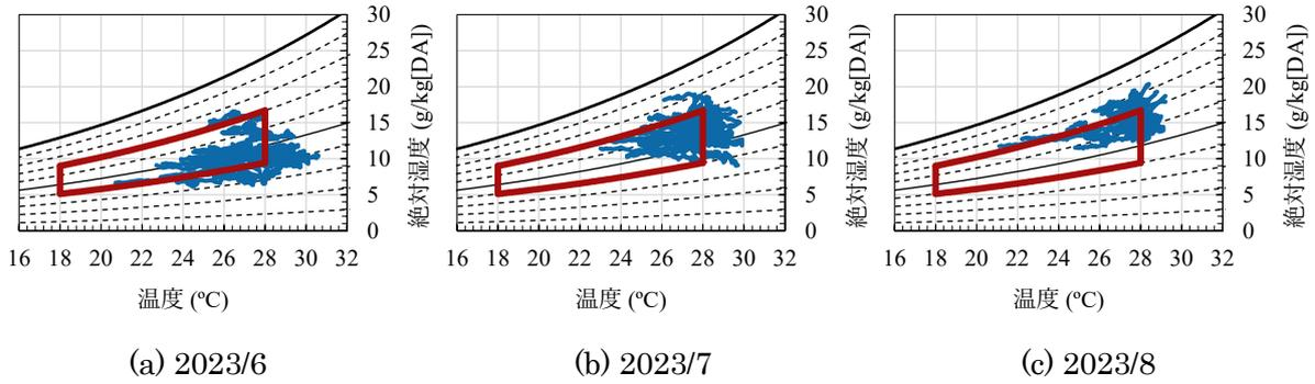
図 3-1-32 室内温湿度 (Bビル1階, 2023/6 - 2023/8, 平日 9 - 18時)
