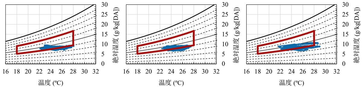
図 3-1-108 室内温湿度 (Gビル3階, 2023/12 - 2024/2, 平日 9 - 18時)
