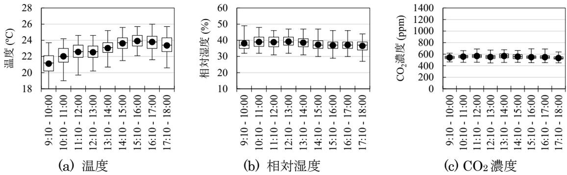
図 3-1-91 室内環境の時別結果 (Dビル4階, 2023/12 - 2024/2, 平日 9 - 18時)
