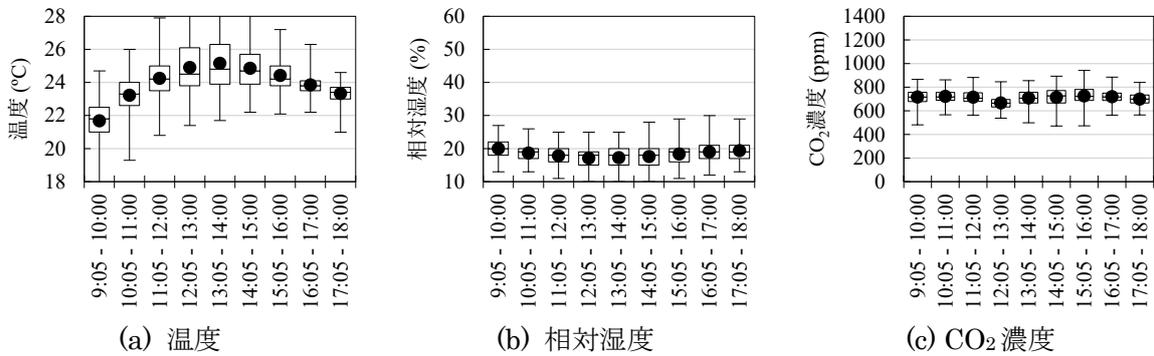
図 3-1-75 室内環境の時別結果 (Bビル1階, 2023/12 - 2024/2, 平日 9 - 18 時)
