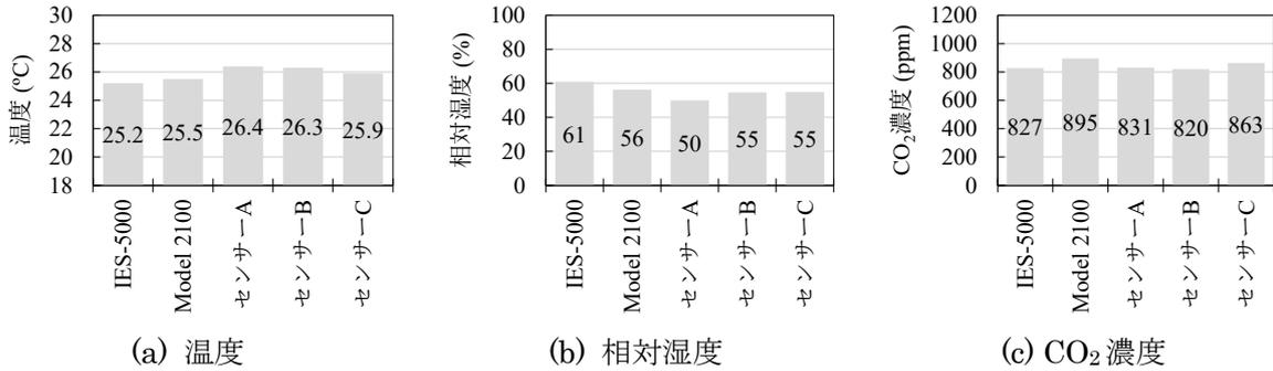
図 3-2-7 小型測定器と現場立入測定の比較 (E ビル, 2023/8/28 15:40)
