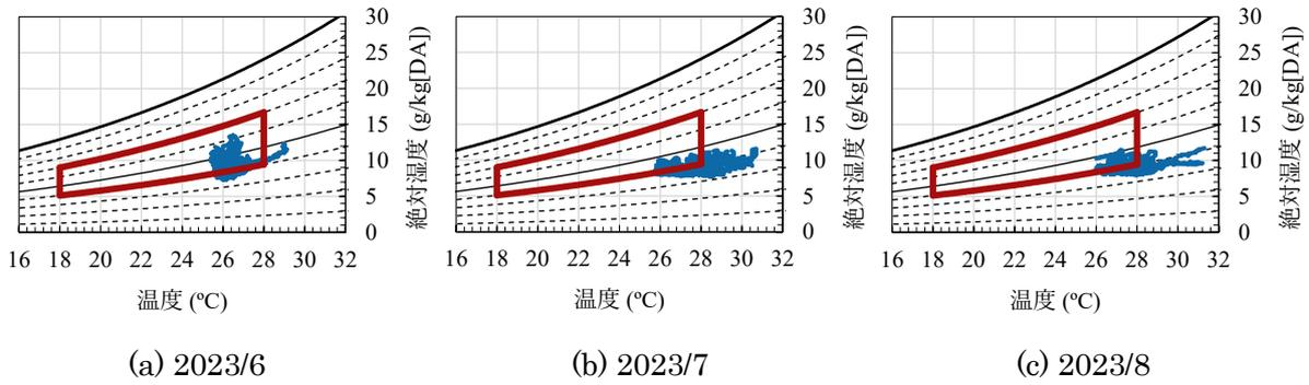
図 3-1-28 室内温湿度 (A ビル 3 階, 2023/6 - 2023/8, 平日 9 - 18 時)
