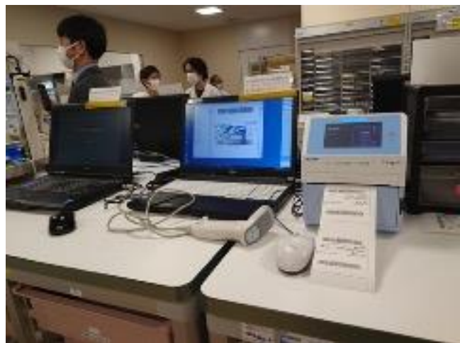
ICU部門システム用のラベル発行システム。在庫管理システムと連動。調製支援システムとも連動。
