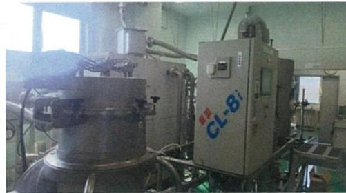
図1 窒素ガス密閉循環型スプレードライヤCL-8iの外観
