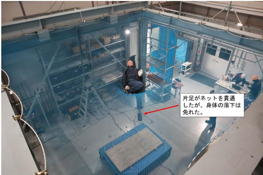
図 2 5 人体モデルの実験結果
