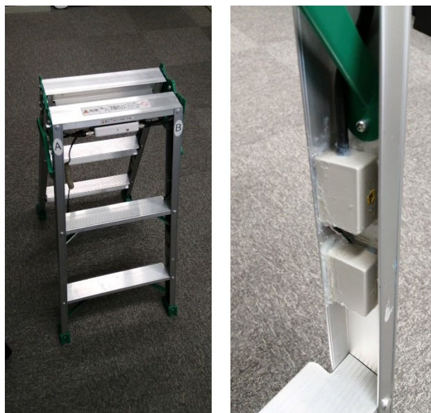
図2 完成したスマート脚立の試作品 (左：本体，右：センサ部)
