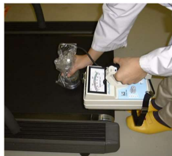
図 5 除染後の表面汚染状況の測定の様子
