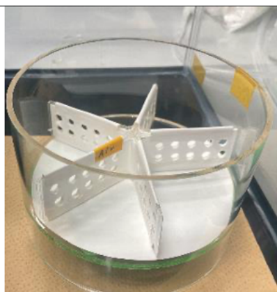
図3 大きな筒状のフォルダーを用いた無拘束曝露装置
