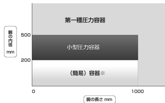
図11 胴の内径と長さによる区分（最高使用圧力 ≤ 0.1MPa）（圧力容器）
