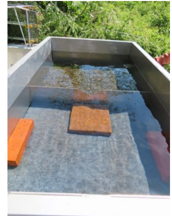
写真2 簡易緩速ろ過装置 とろ過マット
