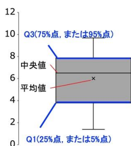
図 3 箱ひげ図による外れ値の除外
