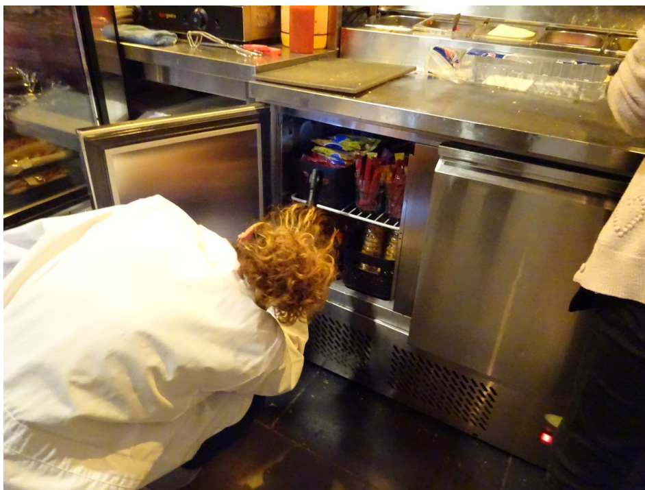
写真２１：冷蔵庫の温度が 4℃であることを確認。カビの発生やパッキンの破損等を懐中電灯を使用して確認。
