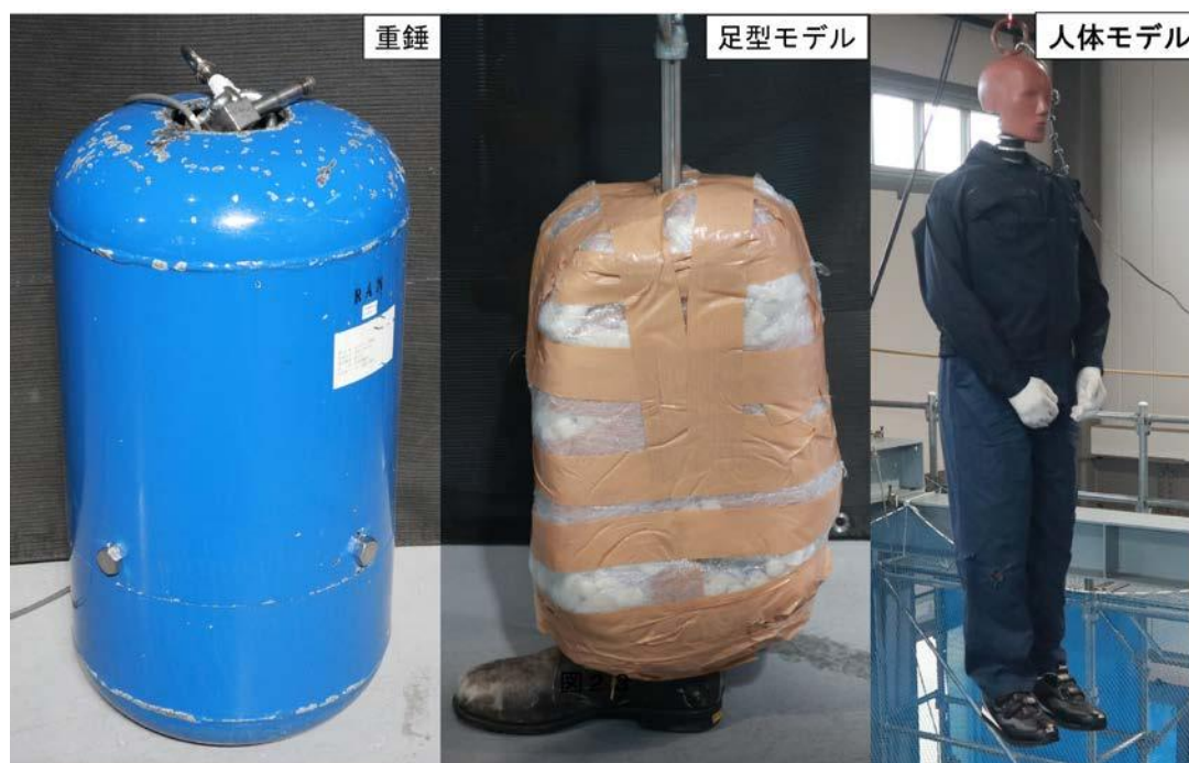
図23 実験で用いた供試体
