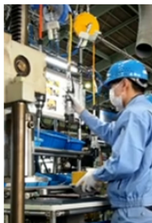
スプリングバランサー*でドリルを吊り下げ、保持
