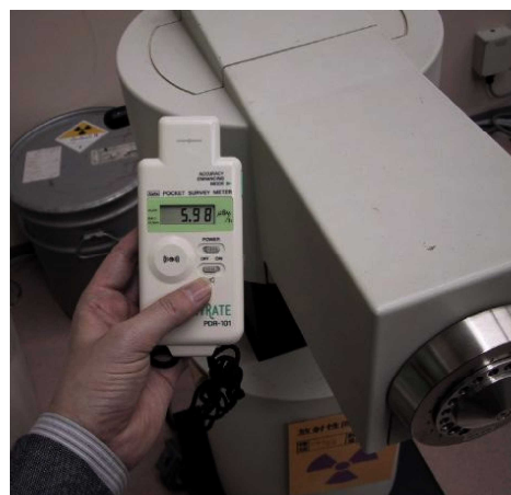
図1 RALS周囲の線量率計測例
