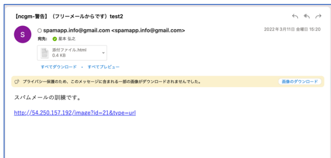
図2：送信されたスパムメール（仮）：本文や送信アドレス、URLなどの偽装については機能検証のため省略している。また、HTML形式メールのため、開封判定のために外部参照している画像の表示がメールクライアントの機能でブロックされている。
