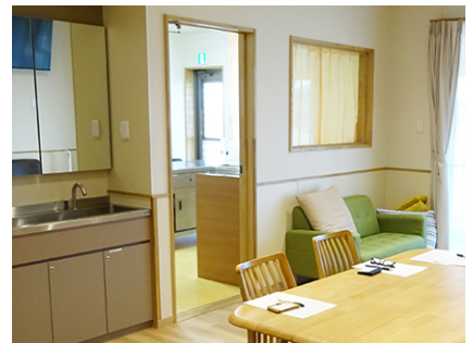
写真12 入居者が自由に入ることができないよう、扉で区画した厨房
