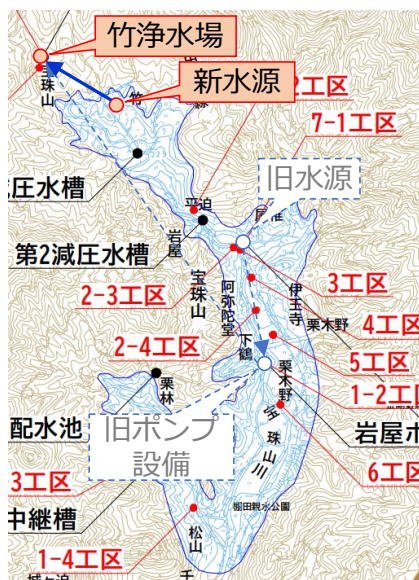
図-3. 本復旧後の竹浄水場導水ルート
