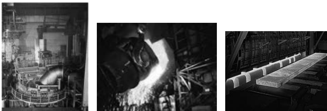
【図表 1-3-2：電気炉・転炉・加熱炉（左から）】
