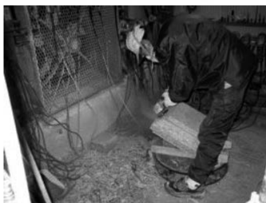
石材店内において、手持ち式の工具を用いて石材の表面を仕上げる作業
