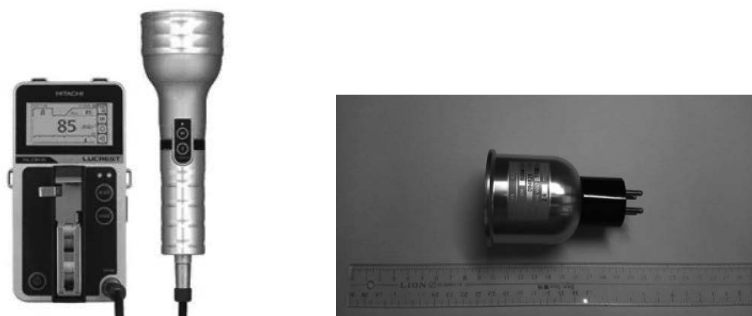
（下左図）GM サーベイメーターの例、（下右図）GM 計数管の外観
