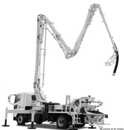
コンクリートポンプ車 61
