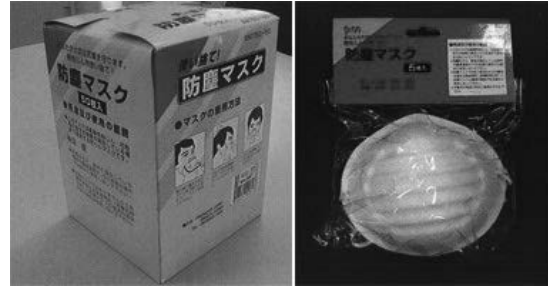
図 4 BM750 防塵マスク（型式検定不受検、サンプル試験において防じんマスク規格不適合。写真は厚生労働省 81 ）
