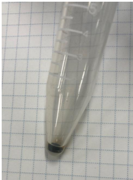
図1 クレオソート油にヘキサンを添加後、遠心処理した時の沈殿物
