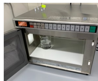
図1 実験に用いた電子レンジおよび300 mL 容ピーカーの測定の様子
