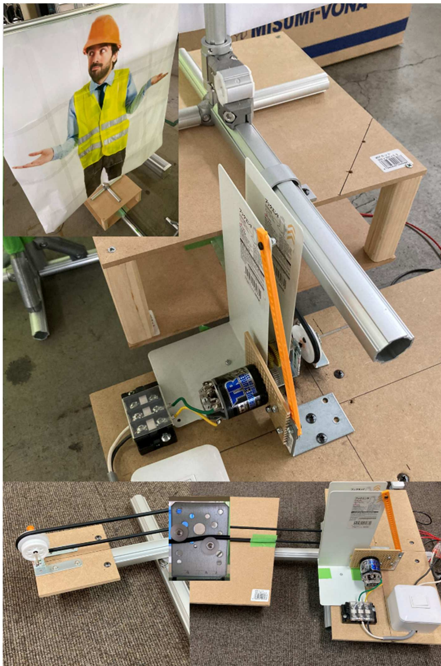
Fig. C-3-3.1 : 動的障害物の模擬装置
