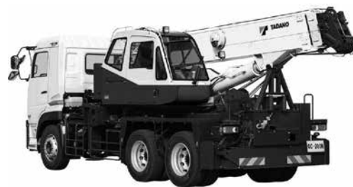
図 21 トラッククレーン
