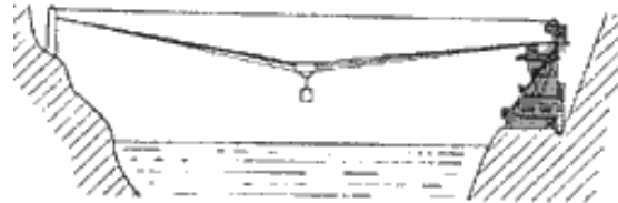
図 15 片側走行ケーブルクレーン
