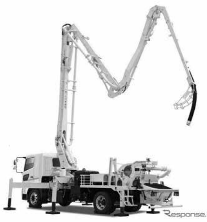
コンクリートポンプ車 61
