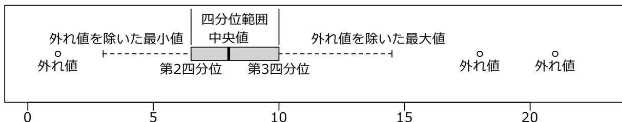
図1 箱ひげ図の描画方法。ひげの先端は最小値、最大値を示すが、ひげの長さが四分位範囲の1.5倍を超える場合は超えた値を外れ値として除き、ひげを描いた。「外れ値非表示」と記して外れ値をプロットしない場合が多い。
