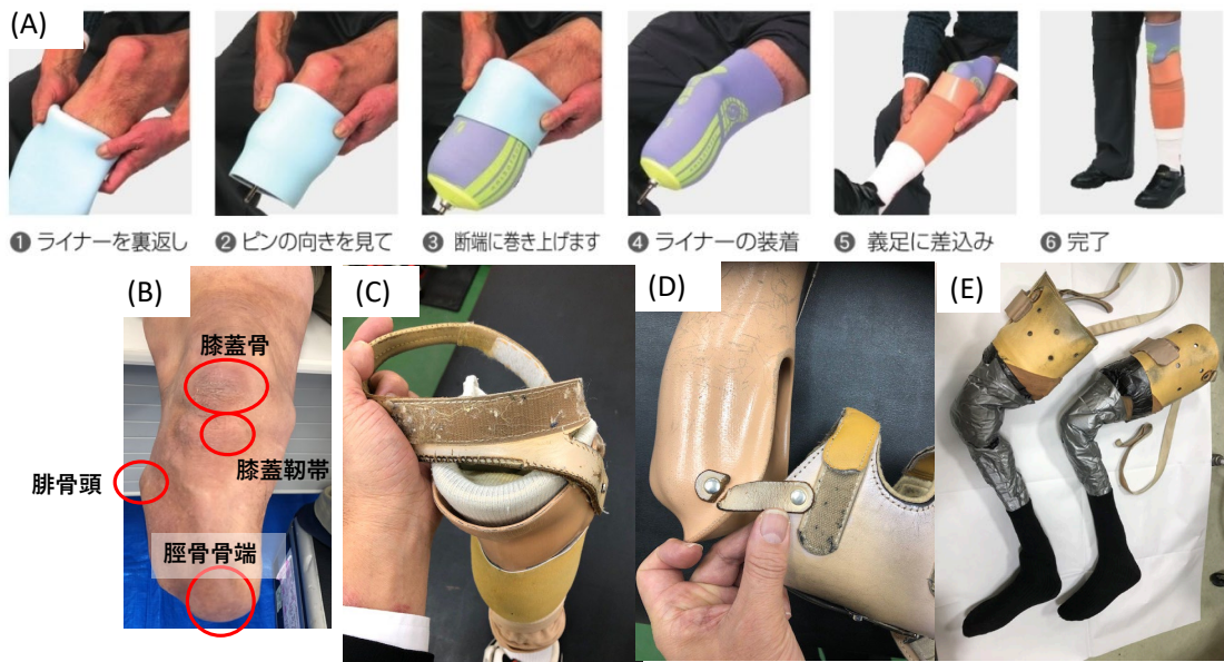
図 2： (A)下腿義足の装着方法例、(B)右下腿断端、(C)下腿義足カフバンドの消耗例、(D)前腕義手革ベルト破損例、(E)大腿義足の外装（フォームカバー）の破損例
