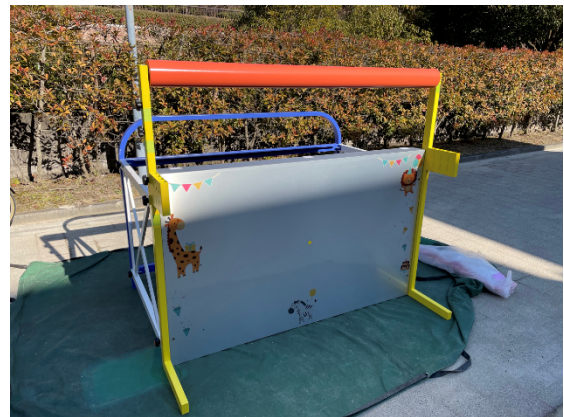
図2 笠木部分がぐるぐる回転する実験機
