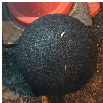
写真 1 洗浄に用いたピグ（ハード）の外観
