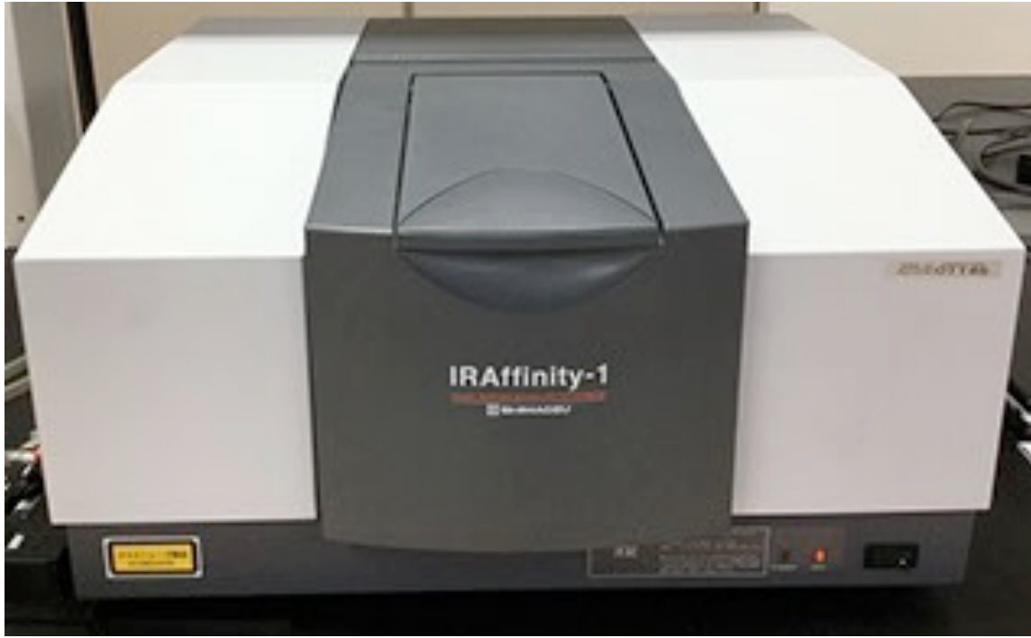
図 1. 測定に用いた赤外分光光度計（榊島津製作所 IR Affinity-1）
