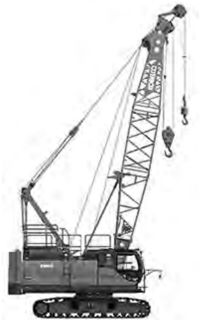
図 18 クローラークレーン
