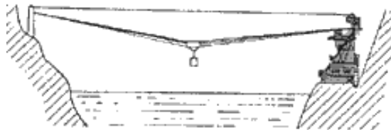
図 15 片側走行ケーブルクレーン
