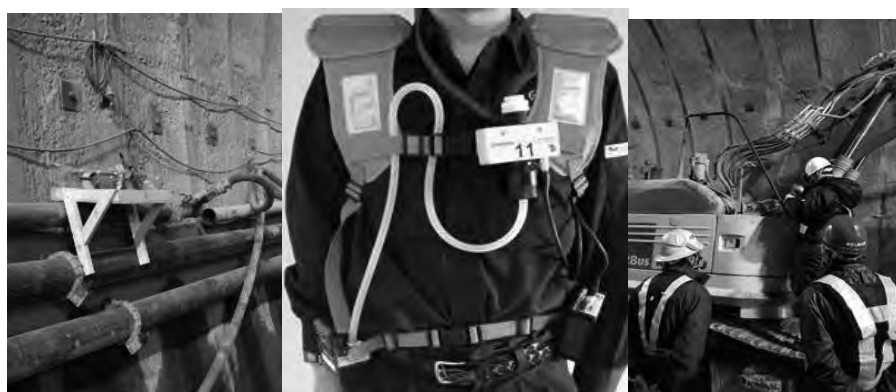
【図表 2-4：定点測定・個人サンプリング・車両系機械を用いた測定（左から）】
