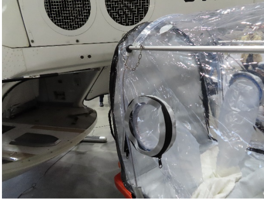
図 18：チャンバー高が搬入口より高い
