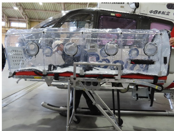
図 13：EC135 の折り畳み脚ストレッチャー
