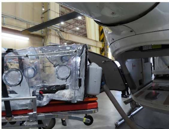
図 16：チャンバー高が搬入口より高い
