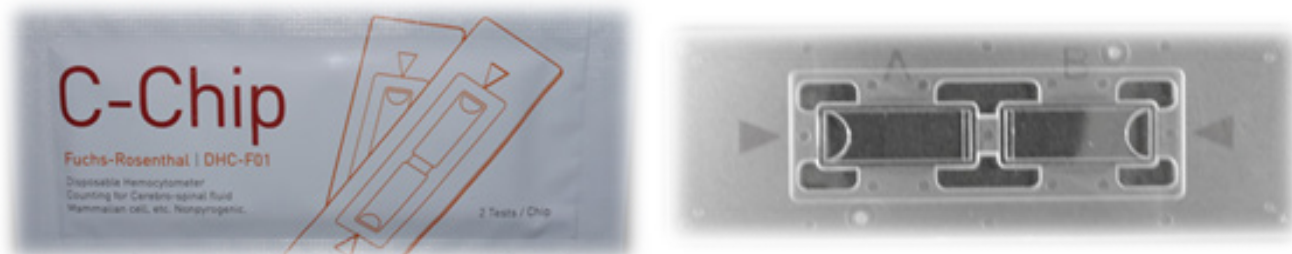
図2 使い捨ての Fuchs-Rosenthal 計算盤。カバーガラスをかける手間も不要で、ケガをするリスクは少ない。廃棄も容易である。
